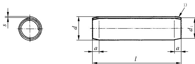
1) 两端挤压倒角。
