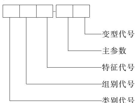
3.2 主参数用距风机中心 2.5 m 处的射流轴线风速(以下简称风速)表示;类别、组别、特征及变型代号均符合 LY/T 1045 的规定。
