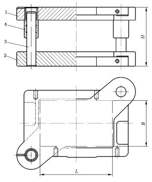
图 1 对角导柱模架
