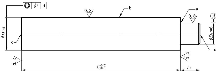
未注表面粗糙度  $R_a=6.3 \mu\text{m}$ ；未注倒角  $1 \text{ mm} \times 45^\circ$ 。
