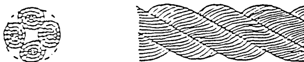
图 2 四股绳索(B 型)的形态图
