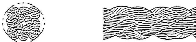
图 3 八股绳索(E 型)的形态图
