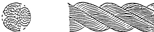
图 1 三股绳索(A 型)的形态图
