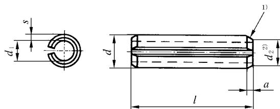
1) 对  $d \geq 10$  mm 的弹性销，也可由制造者选用单面倒角的型式。
