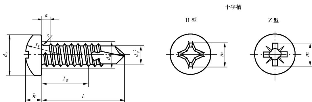
1) 钻头部分(直径  $d_p$ )的工作性能按 GB/T 3098.11 规定。
